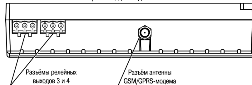
Рисунок 3.2 – Вид на верхнюю поверхность КСОД
